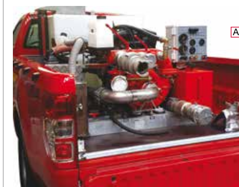
Aménagement de la motopompe
