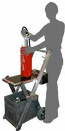
Vérification ergonomique de l'extincteur
