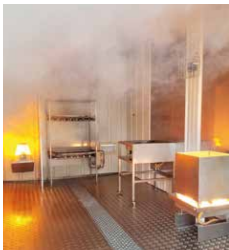
Stratification de la fumée
